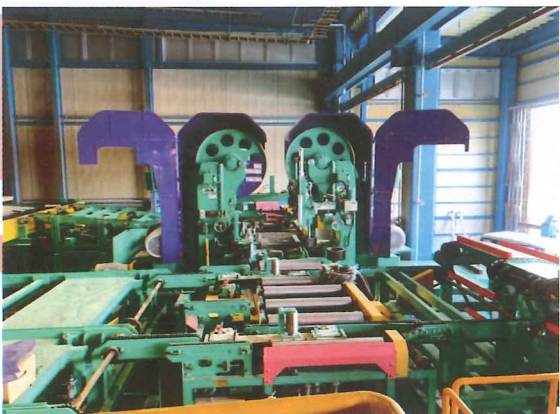
④中心の四角形の材は2枚の刃を持つ機械で柱材・板材として製材されます。
